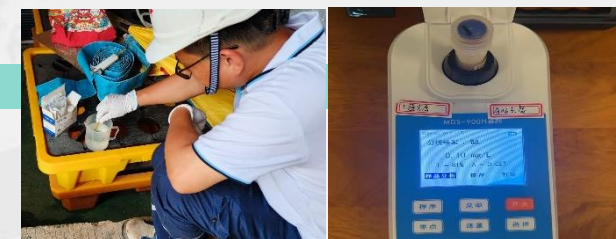
XA1&XA2: 隔2h采取中水池进行含银水质测试，直至水质恢复正常值后，正常排放废水
